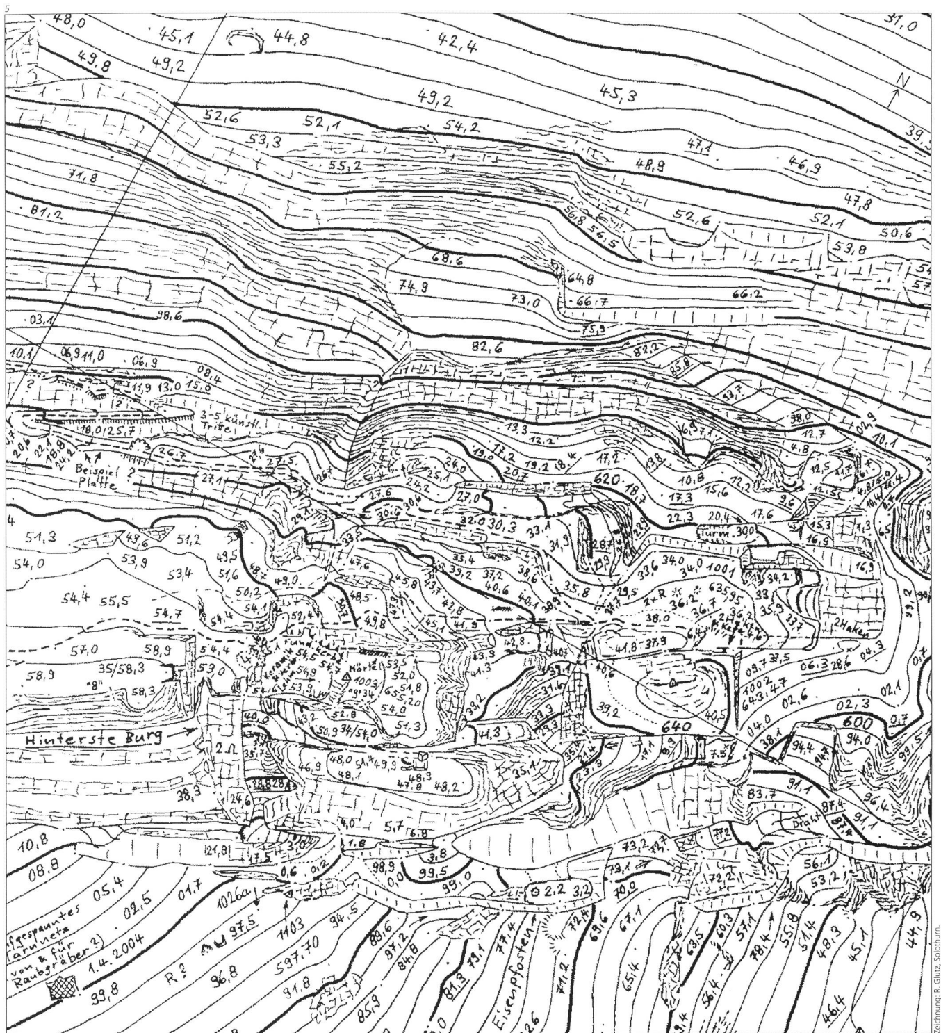
Abb. 5 Ausschnitt aus dem Handriss im Originalmassstab 1:500. Der grosse Felsaufschwung im Nordosten mit der «Hintersten» Erlinsburg und dem aus dem Leutental hochführenden Burgweg war eine der schwierigsten Stellen zum Messen und Zeichnen (vgl. Abb. 13).
