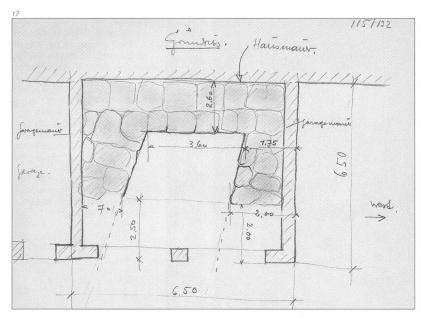
Abb. 17 Dornacherstrasse 29, 1953. Südmauer der Kornhausschanze mit Stützpfeilern.
