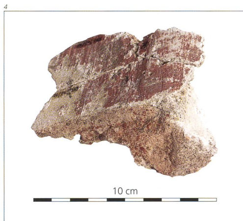
Abb. 3 Wandverputzfragmente der Gruppe 1 mit Kratz- und Schlagspuren von einer Renovation. Der neue Wandverputz (= Gruppe 2) ist auf dem Fragment unten rechts erhalten.
