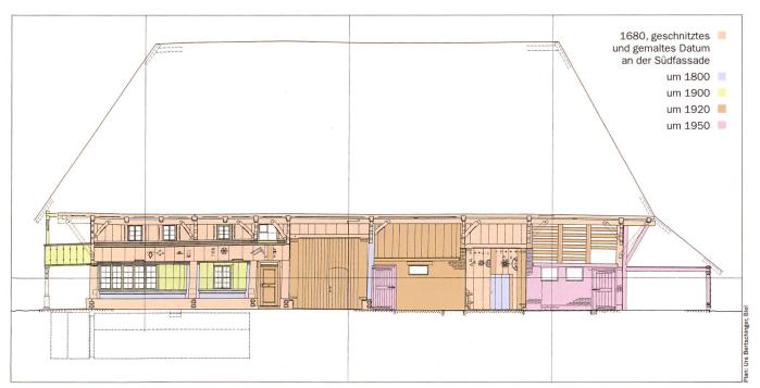
Abb. 3 Zuchwil, Gasserhaus, Bauphasenplan der Südfassade.
