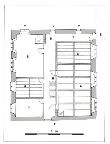
**Abb. 13** Grundriss 1. Obergeschoss, Rekonstruktionsversuch Zustand 1594. **Mit Fragezeichen versehen** Mögliche Tür- und Fensteröffnungen, die durch jüngere Umbauten zerstört wurden. **A** Ehemaliger Saal mit zwei Staffelfenstern nach dem Hof. **B** Stube in der Nordwestecke. **C** Nebenstube. **D** Winkelförmiger Korridor, der vom Kreuzgang **E** durch das Spiesshaus in die Kirche **F** führt. **G** Kleinere Zimmer mit Doppelfenster (Gästezimmer?). **H** Treppenaufgang ins 2. Obergeschoss.
