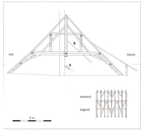
**Abb. 2** Querschnitt durch den Dachstuhl von 1635. **A** Älterer Ortabschluss zum Dach des westlichen Nachbarhauses Gurzelngasse 19 aus spätmittelalterlichen Hohlziegeln. **B** Negativabdruck älteres Dach zu Gurzelngasse 17.
