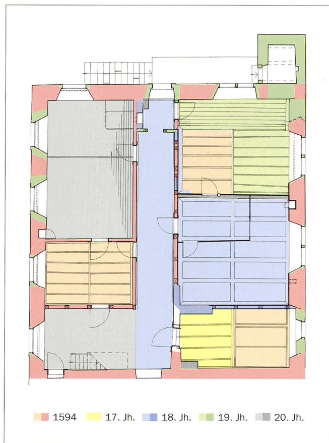
Abb. 14 Grundriss 1. Obergeschoss, Zustand 1999 mit eingezeichneten Bauphasen. Die flächigen Färbungen in den Räumen betreffen die Holztäfer- und Gipsdecken.
