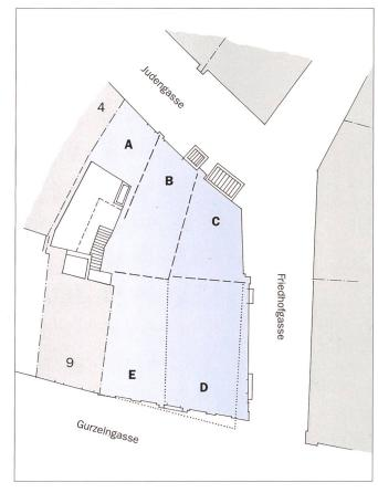
Abb. 1 Situationsplan Gurzelngasse 11. Blau getönt Heutiges Bauvolumen. Strichpunktierte Linien Aktuelle Parzellengrenzen. Gestrichelte Linien Ältere im Bau noch ablesbare Parzellierungen. Punktiert Rekonstruiertes Bauvolumen der beiden Vorgängerbauten vor 1691-93, im Keller noch ablesbar. A-E Die einst selbstständigen Häuser, die zwischen dem späten 17. Jahrhundert und ca. 1750 zur heutigen Liegenschaft zusammen-
