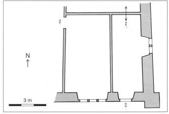
**Abb. 4, 5** Grundriss des Gartenzimmers: links Zustand 2003 nach der Restaurierung, rechts Zustand mit alter Grundrisseinteilung des 16. Jahrhunderts. An den mit Fragezeichen markierten Orten sind Türöffnungen möglich, bauhistorisch aber nicht nachgewiesen.
