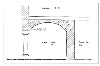
**Abb. 7a** Schema zur Statik im Bereich der Loggia. Bauzeitlicher Zustand mit Zugstange.
