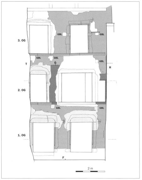
**Abb. 3** Hoffassade Vorderhaus, Planaufnahme nach den baugeschichtlichen Sondierungen und dem Entfernen defekter Verputzpartien.
