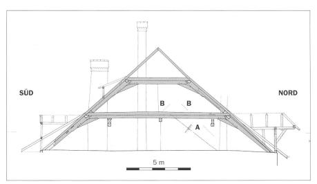
**Abb. 9** Querschnitt durch die Dachkonstruktion, Blick nach Westen an die Brandmauer. Mittelgrau gerastert: Konstruktionsteile von 1596/97. Hellgrau gerastert: Konstruktionsteile von 1714/15. **A** ältere Dachlinie, Phase A, 15. Jahrhundert. **B** ältere Dachlinie Nachbarhaus West. Weiss: Konstruktionsteile 18./19. Jahrhundert.
