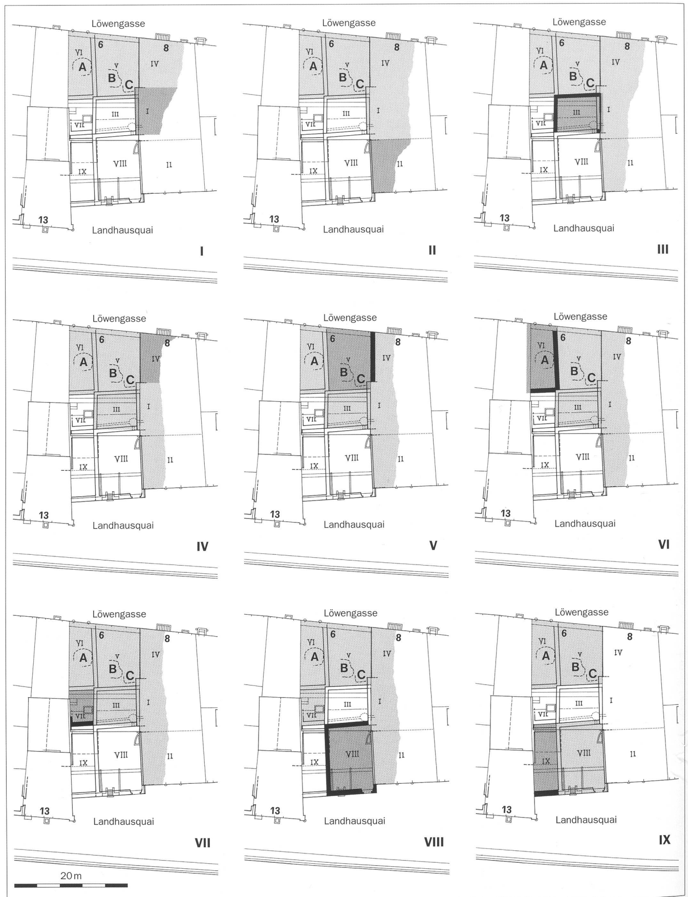
Abb. 8 Gesamtsituation des Grundstücks Löwengasse 6 mit allen Baustrukturen. A, B, C = Grubenhäuser (?) 11. Jahrhundert (?). I-IX = Steinbauten, chronologisch nach ihrem Alter nummeriert, 13.-16. Jahrhundert.
