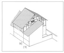
**Abb. 12** Isometrie Phase II, Zustand um 1467, nach der Aufstockung und Erweiterung des Hauses Nr. 5.
