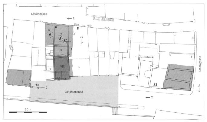
**Abb. 12b** Situationsplan des Häuserblocks zwischen der Löwengasse und dem Landhausquai. Mittelgrau markiert die mittelalterlichen und frühneuzeitlichen Steinbauten im Areal Löwengasse 6 und Landhausquai 11 und 23. Die Pfeile geben die Wachstumsrichtung der Bebauung an. Hellgrau schraffiert der Hafenplatz, dunkelgrau der dominante Bau VIII.
