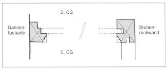
Abb. 3 Profil Auflagerbalken der ehemaligen Bohlendecke in der Stube. Die mit einem doppelkehligen Profil versehenen Balken sind dendrochronologisch ins mittlere 15. Jahrhundert datiert worden.
