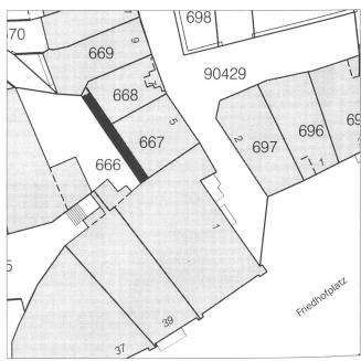
**Abb. 3** Situationsplan Stalden 39, Schmiedengasse 1–7, schwarz gefärbt die 1685/86 neu erstellte Partie der mittelalterlichen Stadtmauer.
