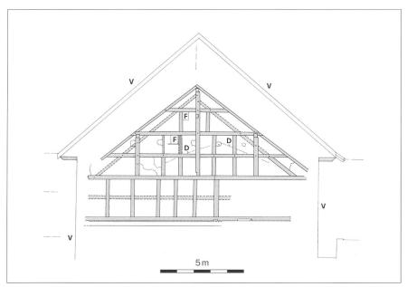
**Abb. 5** Ansicht Brandmauer West. Hellgrau gerastert Ständerkonstruktion Nachbarhaus Klosterplatz 5, dendrochronologisch in die Zeit um 1467 datiert. **F** Fensteröffnungen.
