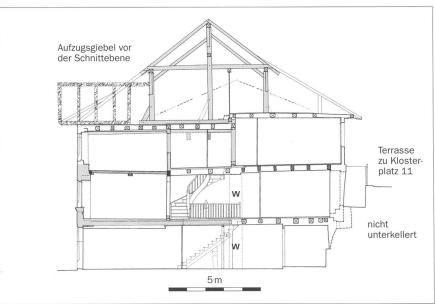
**Abb. 4** Querschnitt, Blick nach Westen, mit Bauphasen. Schwarz = Überreste Bauphase I, dazu gehört auch die punktiert eingezeichnete ehemalige Fassadenmauer W, von der nur Negative erhalten waren.
