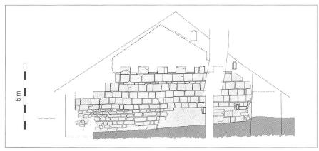
**Abb. 3** Ansicht Brandmauer West im 2.0G und Dachbereich. Zeichnung: M. Hochstrasser. Dunkelgrau = römische Castrumsmauer und Turm. Hellgrau = Ostfassade eines mittelalterlichen Hauses, das am Platz der heutigen Liegenschaft Hauptgasse 27 um 1200 (?) errichtet wurde.
