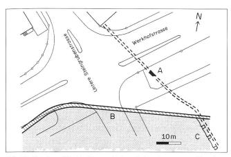
**Abb. 57** Solothurn/Werkhofstrasse-Untere Steingrubenstrasse. Situationsplan mit: **A** Neuentdeckte Wasserleitung; **B** Verlauf der Schanzenmauer nach Leemann 1867–1870; **C** Äusserer Aquädukt. Grau: Schanzengraben.
