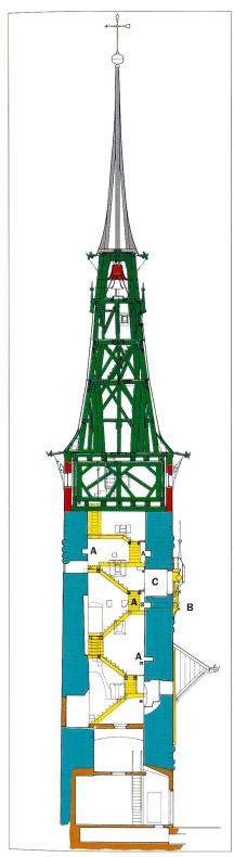
**Abb. 7** Querschnitt durch den Turmkörper, Blick nach Westen. Zeichnung von I. Affolter, Architekturburo P. Flury, Solothurn.
