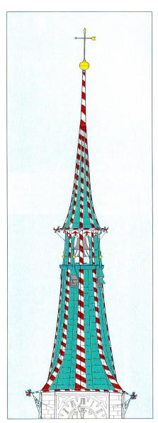
**Abb. 22** Der heutige, mit Kupferplatten beschlagene Helm stammt von 1564. Er war ursprünglich samt den Traufkänneln und den Wasserspeiern polychrom bemalt. Rekonstruktionszeichnung von M. Hochstrasser.
