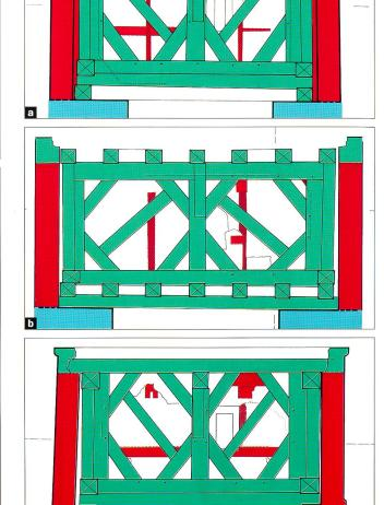
**Abb. 11a–c** Ehemalige Turmwächterstube (heutige Uhrwerkstube). Nord-, Ost- und Südwand, Planaufnahmen nach der Demontage des Wandtäfers. Bauphasenpläne gezeichnet von M. Hochstrasser.
