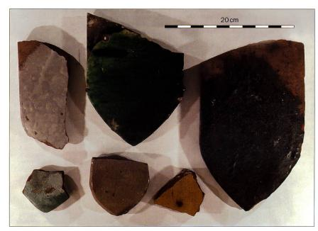
**Abb. 36** Bruchstücke farbig glasierter Ziegel, mit denen der alte Turmhelm einst belegt und bemustert war.
