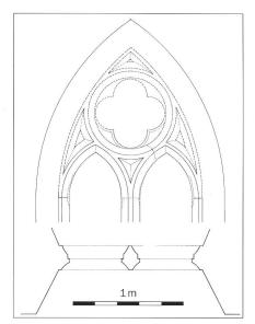
**Abb. 44** Chor, Fenster Süd, Masswerkabschluss. Rekonstruktion des ursprünglichen Zustandes. Die heute noch vorhandenen Teile sind mit ausgezogenen, die 1823–1825 amputierten Teile mit gestrichelten Linien gezeichnet.
