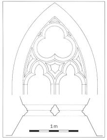
**Abb. 46** Chor, Fenster Südost, Masswerkabschluss. Rekonstruktion des ursprünglichen Zustandes. Die heute noch vorhandenen Teile sind mit ausgezogenen, die 1823–1825 amputierten Teile mit gestrichelten Linien gezeichnet.
