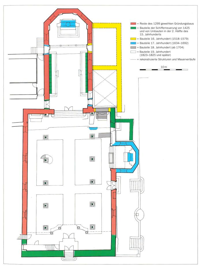
**Abb. 56** Bauphasenplan. Als Grundlage dient der Kirchenaufnahmeplan von 1981. Eingezeichnet sind sämtliche Befunde der archäologischen und bauhistorischen Untersuchungen aus dem Zeitraum von 1922–1996.
