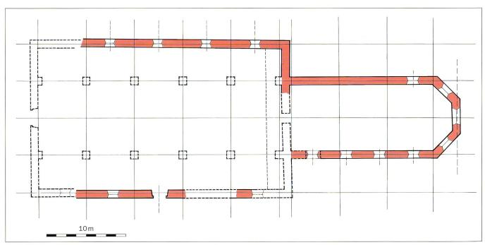
**Abb. 55** Grundriss Gründungsbau, Rekonstruktionsversuch, 1:400. Eingefärbt = heute noch erhaltene Bauteile, Gestrichelte Linien = Rekonstruktion, Stichpunktierte Linien = Fenster- und Türachsen, Feines Netz = Raster im Verhältnis 3:4 (Grundraster).
