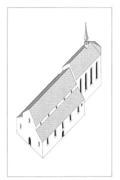
**Abb. 57** Isometrie Gründungsbau. Rekonstruktionsversuch der 1299 eingeweihten Kirche. Die Volkskirche (Schiff) ist als Basilika geformt. Im Osten war sie mit dem heutigen Chor abgeschlossen. Vgl. auch Abb. 56, Phase rot.
