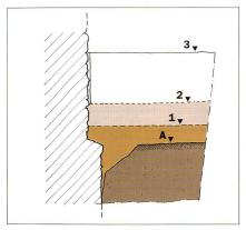
**Abb. 25** Bodenprofil im südlichen Seitenschiff (Umzeichnung nach Tagebuchskizze M. Hochstrasser). Die Schichten lassen ein wiederholtes Anheben des Kirchenbodens (1–3) und das Bauniveau zum Schiff erkennen (A).
