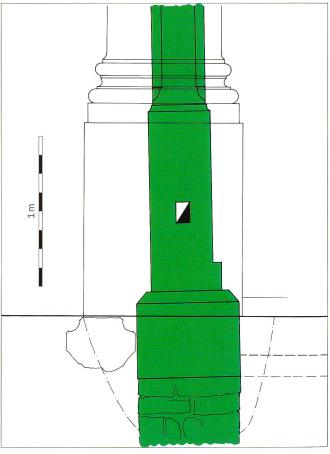
**Abb. 18** Stütze im Schiff, Postament. Eingefärbt der Säulensockel von 1425, wie er unter der Verschalung von 1823/25 erhalten ist. Die Ausnehmungen und Aussparungen stammen von Bänken, die einst in der Schiffslängsrichtung zwischen die Säulen montiert waren.
