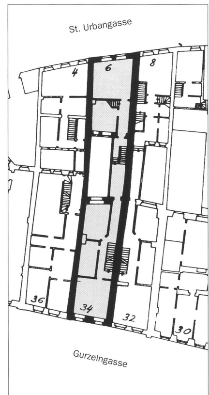
Abb. 6 Ausschnitt aus dem Gesamtgrundrissplan der Altstadt, erstes Obergeschoss von P. Hofer, 1978. Schwarz hervorgehoben die Liegenschaft Gurzelngasse 34/St. Urbangasse 6. Vorder- und Hinterhaus sind durch einen Hof getrennt und untereinander mit einer Laube verbunden.
