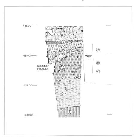
Abb. 11 Solothurn/\*Roter Turm». Profil 10: 1 Torf mit Sand- und Lehmlinsen; 2 grauer Sand mit Lehm und kleinen Kieseln; 3 Lehm mit Sand, Kieseln und Ziegelstücken, dunkelgrau-braun; 4 Lehm mit Sand, Kieseln und Ziegelstücken, braun-schwarz; 5 Lehm mit Steinen, ocker; 6 verbrannter Lehm, rot; 7 Lehm und Kiesel, gelb; 8 humoser Lehm, braun-schwarz; 9 lockerer Schutt mit Steinen, Ziegel, Mörtel; 10 grauer Lehm; 11 «Torf», locker; 12 lockerer Schutt.
