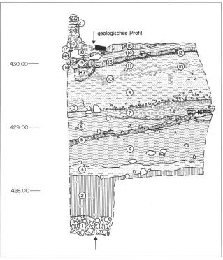
Abb. 6 Solothurn/«Roter Turm». Profil 3: **1–8** siehe Abb. 5; **9** sandiger Lehm, hellgelb bis grau, Kiesel an der Grenze zu Schicht 7; **10** dunkelbraunes Band, sich nach Osten in mehrere Bänder aufteilend; **11** sandiger Lehm, hellgelb bis grau; **11a** grauer Lehm; **12** Brandschicht; **13** und **13a** sandiges Humusband, dunkelbraun; **14** hellbraunes Band; **14a** siehe Abb. 5; **15** ?; **16** Humus, dunkelbraun; **17–22** siehe Abb. 5.
