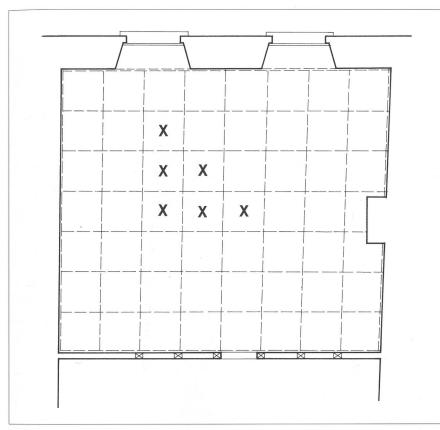
**Abb. 3** Grundriss des ehemaligen Saals. Gestrichelt die Feldereinteilung der Täferdecke. Mit X bezeichnet die 1980 entfernten Tafeln.
