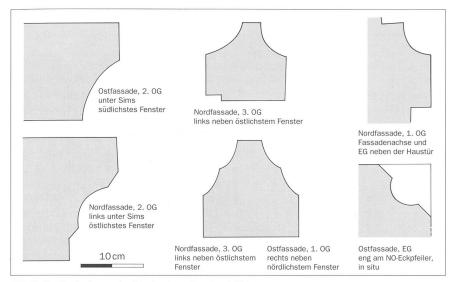
Abb. 4 Profilaufnahmen der Sandsteinspolien von 1551.
