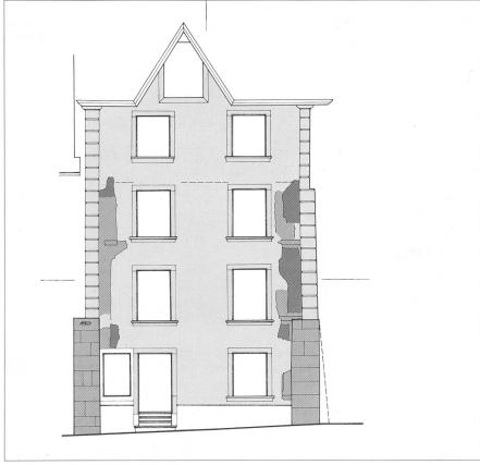
Abb. 3 Bauphasenplan der Ostfassade.
