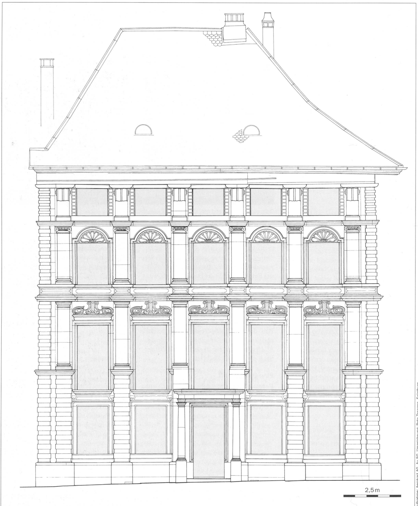
Abb. 1 Solothurn, Reinerthaus. Die Fassade des Hauses Gurzelngasse 11, Umzeichnung der fotogrammetrischen Aufnahme. Bestandesaufnahme 1997. Bewusst weggelassen sind die geschmiedeten Gitter und die Schreinerarbeiten (Fenster/Türen).
