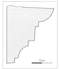
**Abb. 12** Dieses Profilstück muss als Muster gedient haben. Es ist speziell in der gefundenen Abmessung produziert worden und trägt keinen Anstrich.
