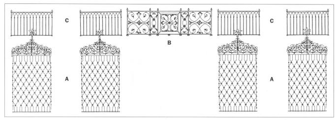
**Abb. 5** Die aus drei verschiedenen Zeitepochen stammenden Schmiedeeisengitter (Auszug aus der fotogrammetrischen Aufnahme). **A** Fenstergitter im Parterre aus der Bauzeit, 1693. **B** Balkongitter über dem Hausportal, um 1720/30. **C** Brüstungsgitter vor den Fenstern der Beletage, um 1810/20.
