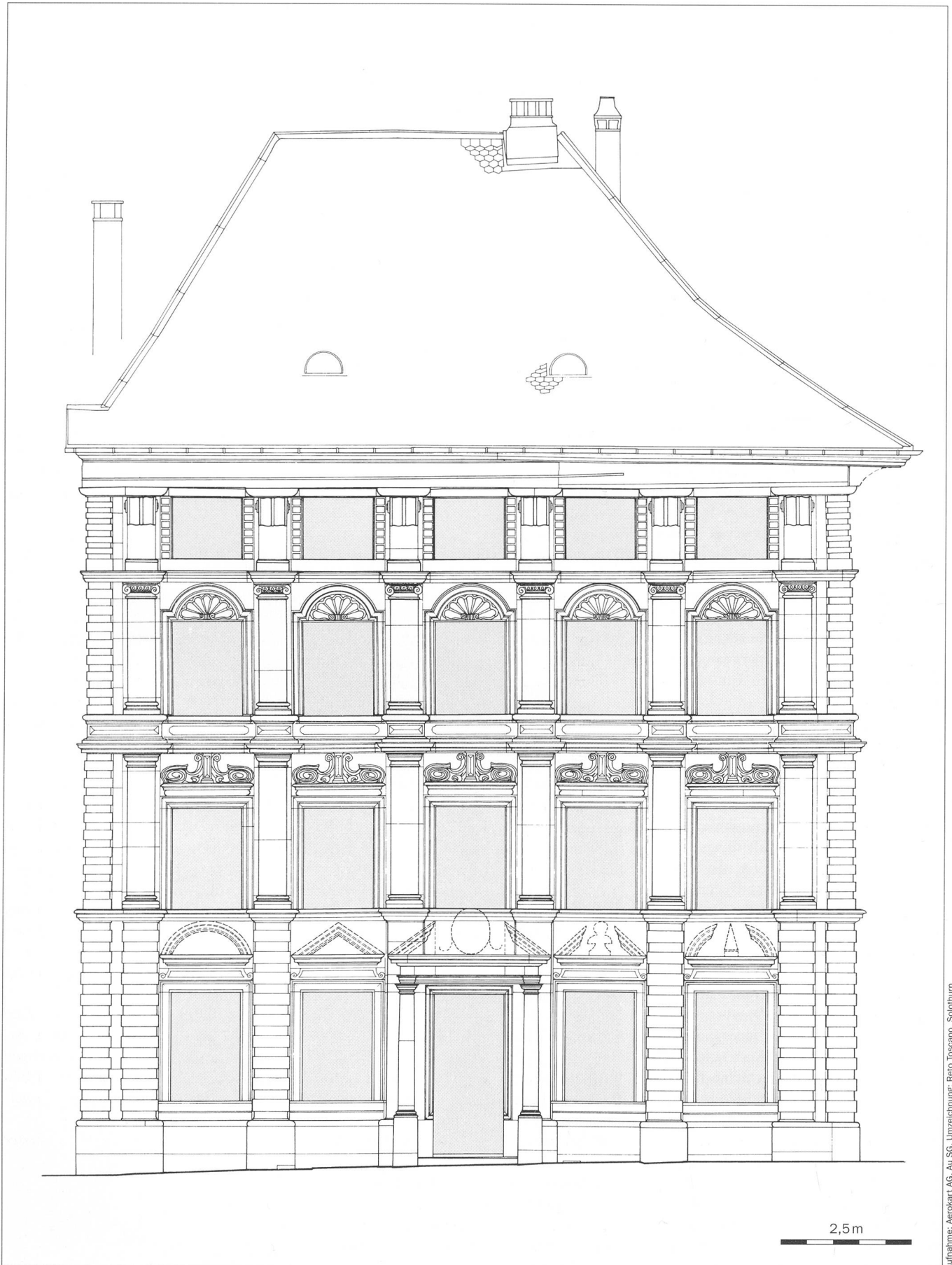
Abb. 4 Die Fassade des Hauses Gurzelgasse 11, Rekonstruktion des Zustandes vor den Umbauten im 18. und 19. Jahrhundert.
