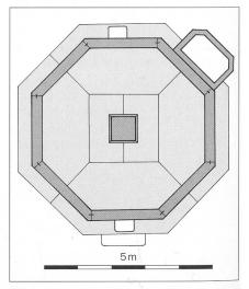
Abb. 6 Grundrissaufnahme des Brunnens, erstellt anlässlich der Renovationsarbeiten im Juni 1997. Der Beckenboden besteht aus sechs mächtigen Kalksteinplatten, die an den Stossstellen überfälzt sind.
