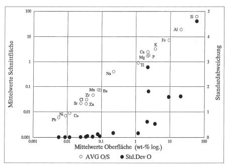
**Abb. 23** Spektrometer der 36 Keramikproben. ED-XFA Spectrace 3000, Geochemisches Labor MPI, Universität Basel. Parameter: 2mm Kollimator, 5mm PLX-Masken, 8KV/0.80mA/no Filter/100sec; 25KV/0.80mA/Ag-Filter/100sec; 50KV/0.80mA/Cu-Filter/100sec.
