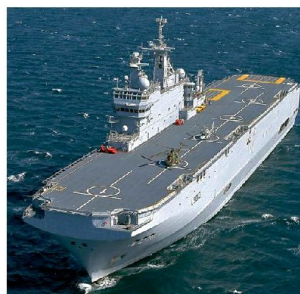
Trägerschiff der «Mistral»-Klasse kann 16 Helikopter und rund 60 gepanzerte Fahrzeuge transportieren. Bild: Armée Française
