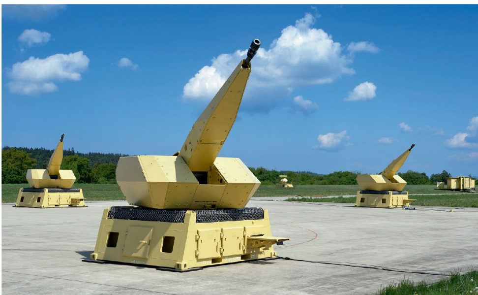
Luftabwehrsystem «Mantis» zur Bekämpfung von RAM-Zielen.
