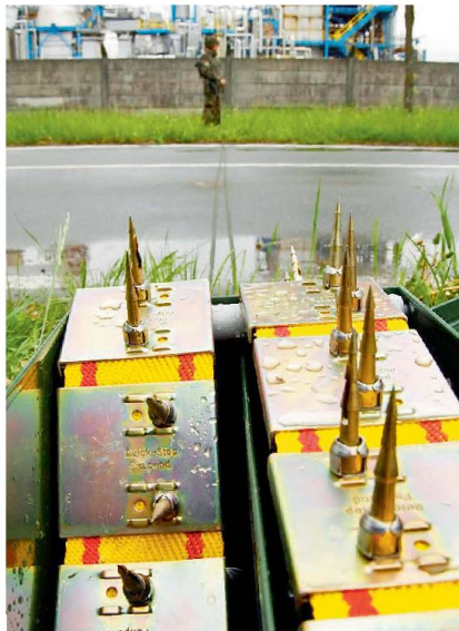
Nagelgurte im Einsatz.
