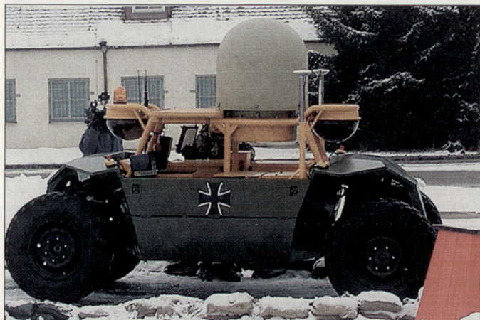
Versuchsträger des unbemannten Roboterfahrzeuges «Gecko».
