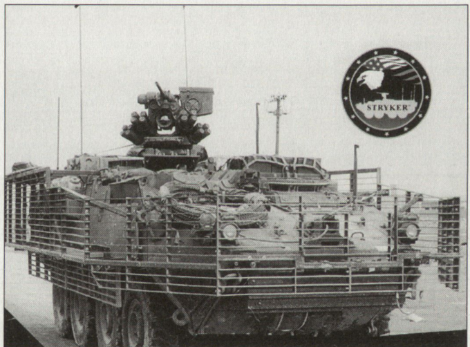
Schützenpanzer «Stryker», ausgerüstet mit Hohlladungsschutzgitter beim Einsatz im Irak.
