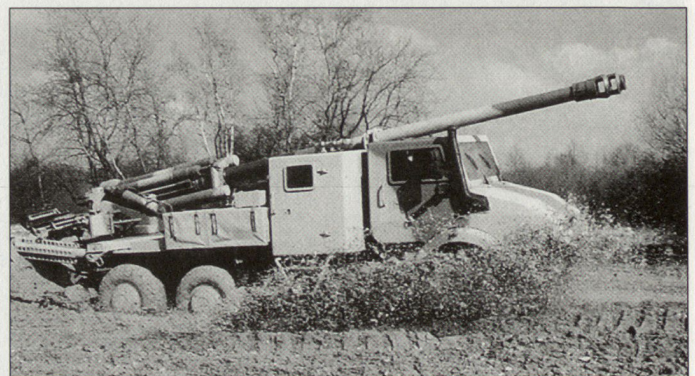
Leichtes mobiles Artilleriesystem «Caesar» vom Kaliber 155/52 mm.
