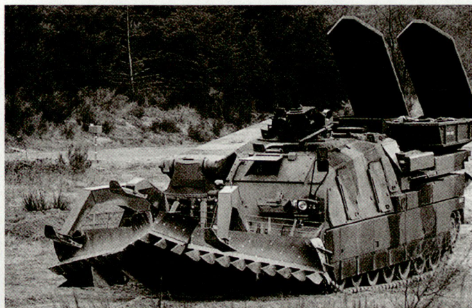
Geniepanzer «LeClerc DNG» ausgerüstet mit Kranausleger, Räum-schaufel und Minenräumgerät.
