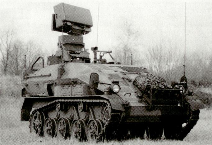
Luftlande-Fahrzeugfamilie «Wiesel 2» (Prototyp eines Radarfahrzeuges für Luftraumüberwachung).
