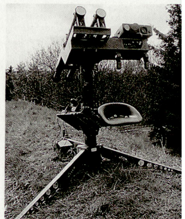
Zwillings-Abschussvorrichtung für die Flab-Lenk Waffe «Stinger».
