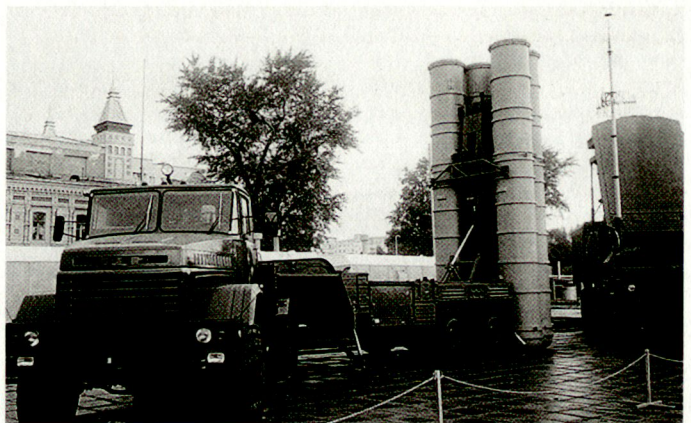
Flab-Lenkwaffensystem S-300PMU-1, Abschussystem mit dazugehörigem Feuerleitradar.
