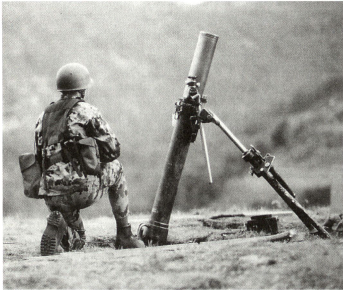
Abb. 1: Schwerer Minenwerfer 12 cm. (Armee fotodienst)
