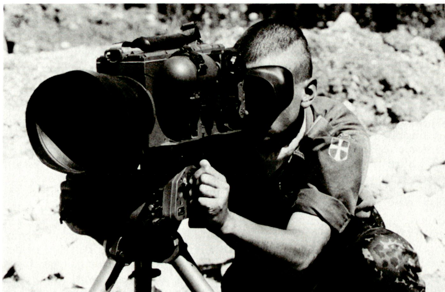
Kalibrierung eines Nachtsichtgerätes für Beobachtungsaufgaben in der Dunkelheit. Dänischer Blauhelmsoldat in der UNPROFOR (Ex-Jugoslawien). (UN Foto 159283/J. Isaac)
