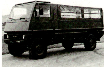
Der Militärlieferwagen 2 t «DURO», 4x4 geländegängig, 4-Gang-Automat. 6 Zyl, VM-Diesel, 110 kW bei 4200 U/min.
