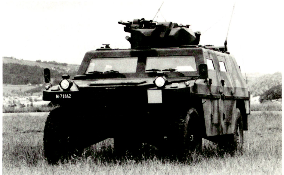
Leichtgepanzertes «Mowag»-Aufklärungsfahrzeug. Höchstgeschwindigkeit 105 km/h, Dieselmotortyp 6,2 Liter, 150 PS.
