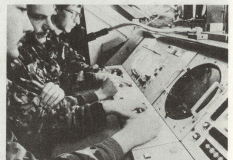
Das Kommandopult des Feuerleitgerätes SKYGUARD . Hier wird der Einsatz der 35-mm-Flab gesteuert.
