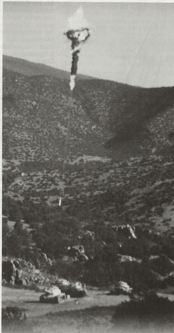
Bild 4. Test einer Suchzündermunition SADARM von Aerojet auf dem Versuchsgelände der Sandia Laboratories, Albuquerque, New Mexico. Ein vom integrierten, kombinierten Millimeterwellen-Radar-/Infrarot-Sensor ausgelöstes Zündsignal hat vor Sekundenbruchteilen die Detonation der projektilbildenden Ladung eingeleitet. Gut sichtbar ist das soeben entstandene, durch die Detonation geformte Projektil (Slug; v_0 etwa 2000 m/s), das den Panzer an seiner schwach geschützten Oberfläche durchschlägt wird.
