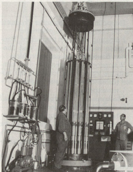
Teil der Gas-Nitrieranlage mit rechnergestützter Prozesssteuerung.
