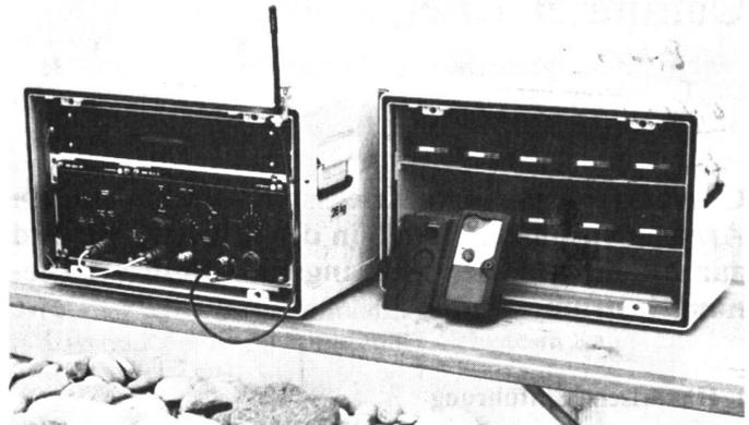
Bild 1. Links Sender, rechts Empfänger (wie Messgerät A 73).
