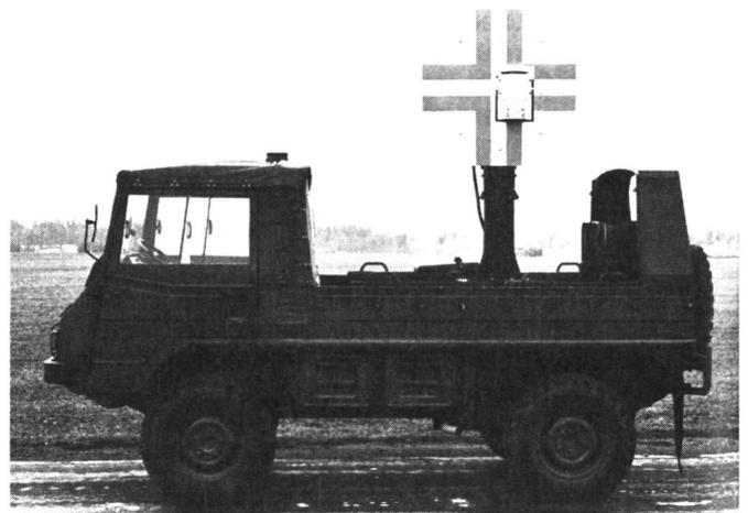
Bild 2. Zielfahrzeug mit Infrarotsender.
