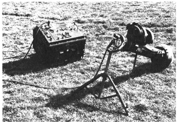
Bild 1. Abschuss-Simulator mit Überwachungsgerät.
