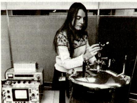
avigationssystem verfügen, das auf der natürlichen Drehung der Atomkerne beruhen wird, und nicht auf der etwa für ein Spinnrad kennzeichnenden Trägheit. Hier wird im Laufe von am Admiralty Compass Observatory in Südengland durchgeführten Versuchen ein Prüfgerät an einen cryostatischen Kühlbehälter angeschlossen.
