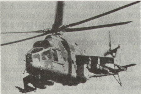
Bild 4. Mi-25 «Hind» ist der erste sowjetische Kampfhubschrauber mit Raketenwerfern UV-32-57 und drahtgelenkten Panzerabwehrraketen «Sagger» unter den Flügeln. In der Kabine finden bis 12 Soldaten Platz.
