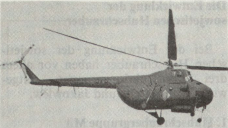
Bild 1. Mittlerer Hubschrauber Mi-4 «Hound» mit zweiteiliger Ladeforte am Rumpffende und Bodenwanne mit oder ohne Bewaffnung unter Rumpfvorderteil.
