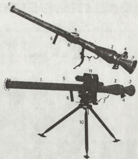
1 Lauf, 2 Zündungskammer, 3 Düse, 4 Verbindungsklammer, 5 Abzug, 6 Abzugsicherung, 7 Schulterstütze, 8 Zielvorrichtung, 9 Mündungsbremse, 10 Dreifuss, 11 Zielvorrichtung mit Entfernungsmesser
