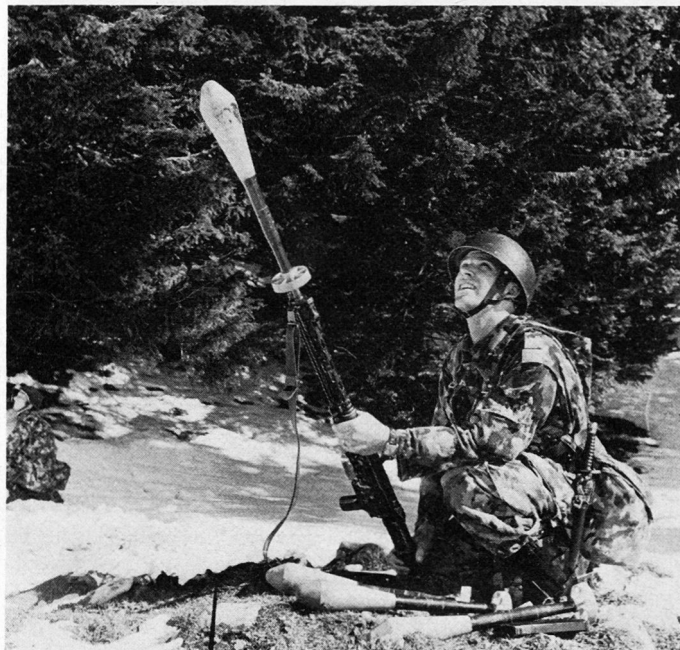
Bild 10. Bogenschuß jägermäßig: einfach – rasch – sicher. 45° Elevation = 140 m Schußdistanz, ohne Zusatztreibladung. Aus der Deckung in die Deckung. Feuerleitung durch Trupp- oder Gruppenführer.
