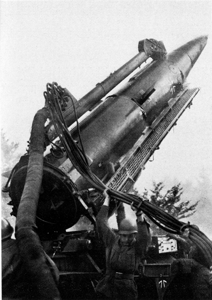
Bild 7. Die taktische Boden/Boden-Rakete MGM 31A «Pershing» geht in Stellung. Es handelt sich um eine Zweistufen-Feststoffrakete mit einem Startgewicht von 13,6 t, einer Reichweite von 600 bis 800 km. V_{max} = 4800 \text{ km/h} mit Trägheitslenkung. Länge: 10,54 m, Durchmesser: 990 mm. Die deutsche Luftwaffe besitzt 2 Geschwader von dieser Waffe, die der NATO unterstellt sind. Die «Pershing»-Batterie verfügt über eine Abschubrampe mit 4 Einzelfahrzeugen: Raketenträger mit Aufrichtvorrichtung, Transportfahrzeug für die zweite Stufe mit Gefechtskopf, Feuerleit- und Prüffahrzeug, Fernmeldefahrzeug. Das Ganze basiert als Einheitsfahrzeug auf dem MTW M 113.
