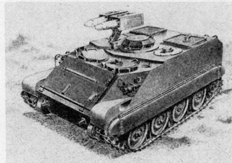
An einem weiteren Versuchsfahrzeug sind 2 Raketen im Behälter auf einem Pivot angeordnet.
