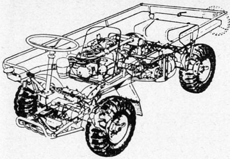
jedem Soldaten bedient, mit Fallschirm abgeworfen oder aufeinandergestapelt transportiert werden. Die Nutzlast beträgt 500 kg.
