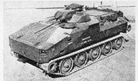
der Selbstfahrgeschützreihe M 107/M 110 übernommen. Die Geschwindigkeit des Fahrzeuges beträgt 60 km/h, der Aktionsradius über 600 Kilometer. Die Bewaffnung besteht aus einer in einem Drehturm montierten 20-mm-Kanone und einem koaxialen 7,62-mm-Maschinengewehr. Die elf Mann Besatzung können im Nahkampf das Feuer mit der persönlichen Waffe aus Schützenlücken aufnehmen. Durch spezielle Öffnungen können Handgranaten aus dem Fahrzeug geworfen werden, ohne daß sich der Schütze exponieren muß. ps
