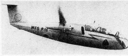
mit der Kleinstgeschwindigkeit von 0 km/h schweben und gleich darauf in die Höchstgeschwindigkeit von 670 km/h übergehen kann, soll vor allem als Gefechtsfeldaufklärer, Helikopterjäger, Heeresunterstützungsflugzeug oder Übungsflugzeug Verwendung finden.
