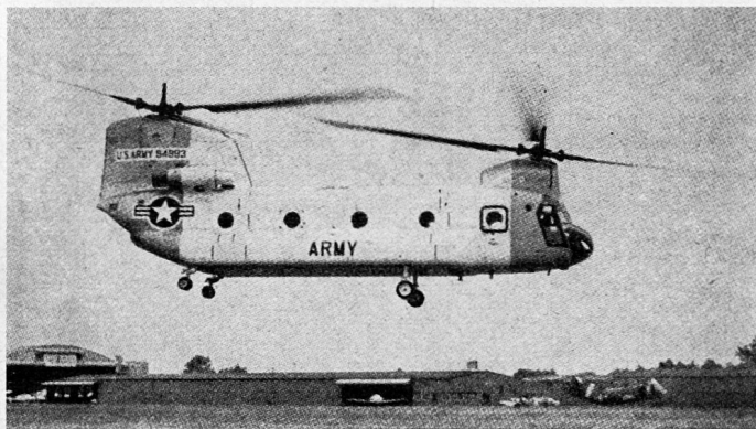
Bild 11. Vertol - 107 - Chinook Kann bis 26 ausgerüstete Soldaten mitnehmen oder 6 Tonnen Last 2 Triebwerke mit je 2200 PS Leistung
