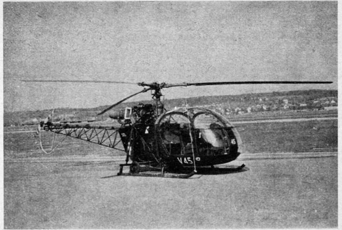
Bild 16. Die Alouette III. Maximal 5 Passagierplätze Ein Triebwerk Alouette II von 400 PS Maximales Startgewicht 1500-1600 kg. Rotordurchmesser 10,2 m
