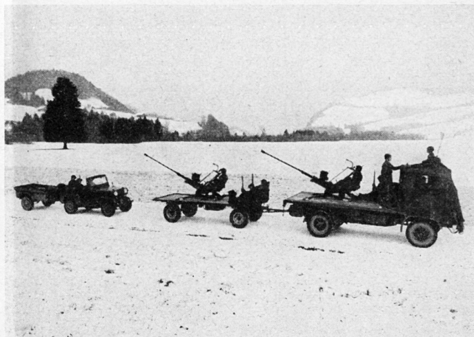
Bild 1 Flab-Gruppe mit improvisierter Selbstfahrlafettierung auf Lastwagen und Gepäckanhänger
