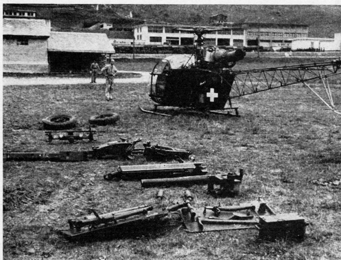
Bild 2. 7,5 Gebirgskanone, in Bastlasten zerlegt
