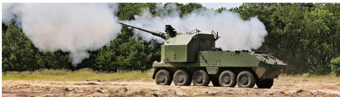
Das 155-mm-Artillerie-Geschütz-Modul AGM auf dem 10x10-Trägerfahrzeug Piranha IV von Mowag kann über 360 Grad wirken. Bild: KNDS/GDELS
