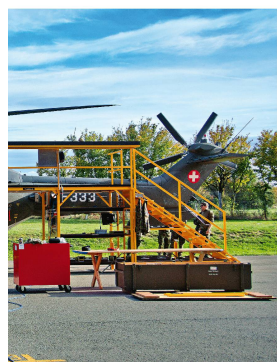
◀ Auf dem Waffenplatz Bière mussten die Rotoren demontiert werden, um die Helikopter in der Halle unterbringen zu können. Bild: PIO TA1
