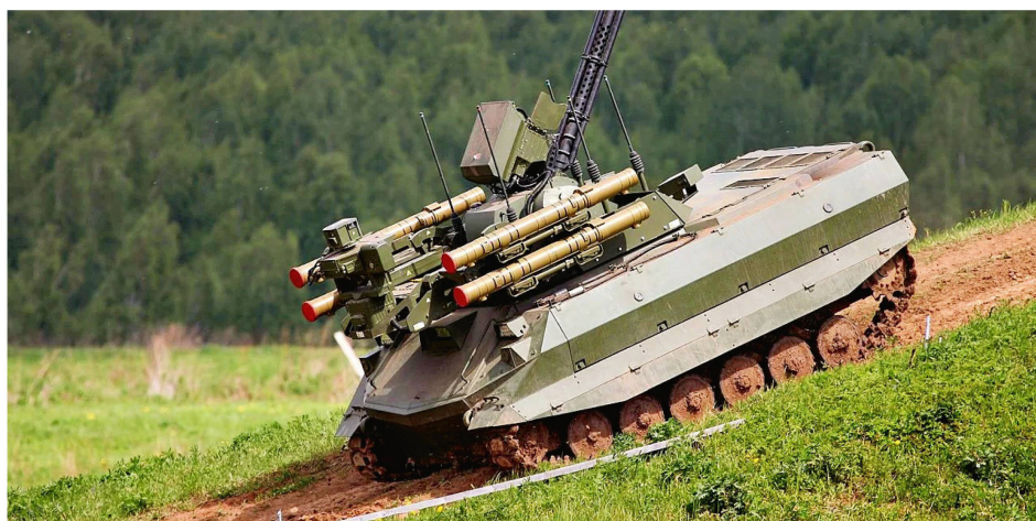
Ein Prototyp des Kampfrobooters Uran-9, der mit Automatenkanone und Panzerabwehrlenk Waffen bewaffnet ist. Bild: Russisches Verteidigungsministerium
