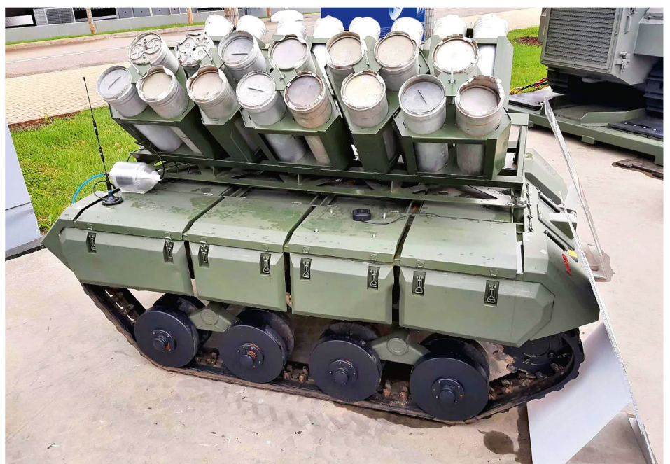
Das unbemannte Minenstreusystem Impulse-KPTM wird für die autonome Verlegung von Personen- und Panzerminen eingesetzt. Bild: Armiya 2024
