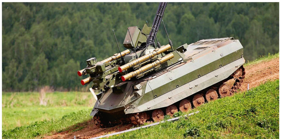
Ein Prototyp des Kampfroboters Uran-9, der mit Automatenkanone und Panzerabwehrenk Waffen bewaffnet ist. Bild: Russisches Verteidigungsministerium
