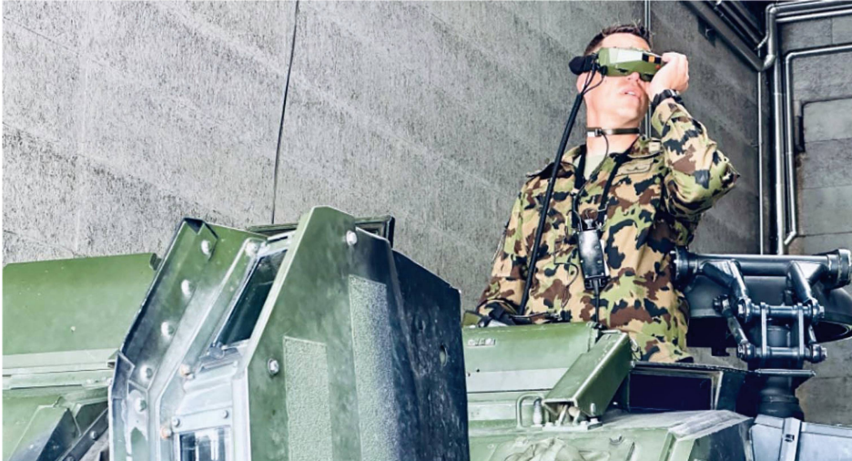
Versuche sollen zeigen, ob Panzerbesatzungen mit digitalen Mitteln eine besser Rundumsicht erhalten. Bild: Swiss Innovation Forces
