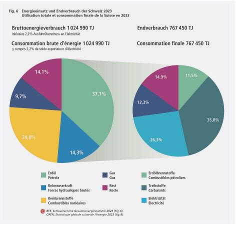
Aufteilung des Endverbrauchs nach Energieträgern. Eine genaue Einteilung ist kompliziert, da beispielsweise gewisse Kehrichtverbrennungsanlagen mit der erzeugten Wärme sowohl Strom als auch Fernwärme produzieren. Grafik: BFE
