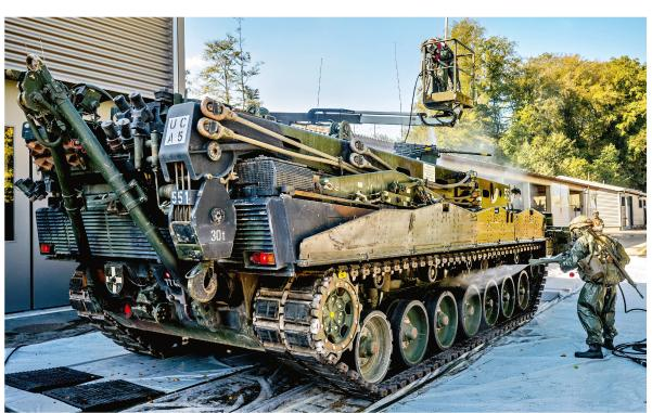
Ein Panzer wird dekontaminiert. Bild: VBS
