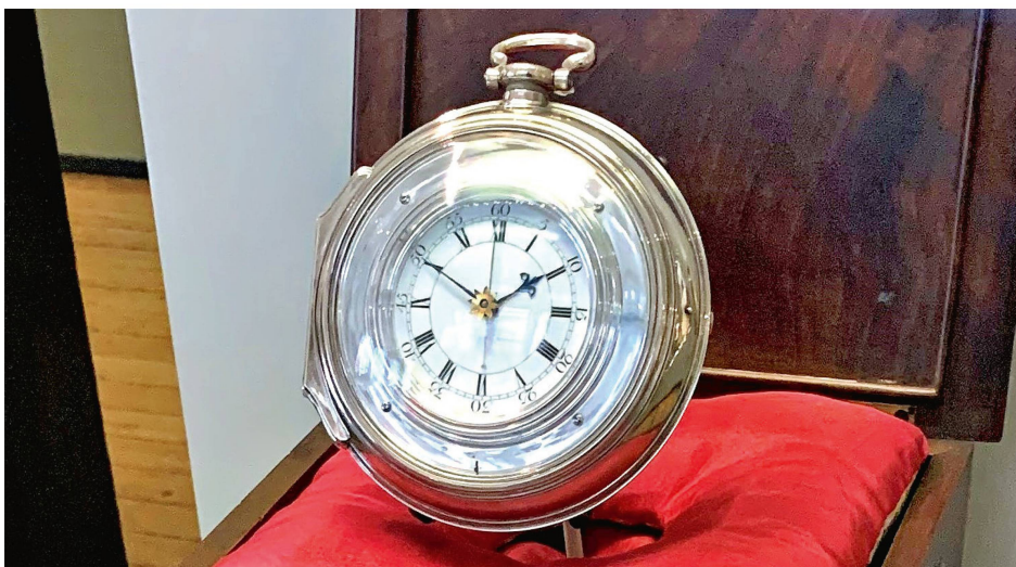
Marinechronometer H-5 von John Harrison (1693–1776). Schlicht und schön. Ein früher Inbegriff genauer Zeitmessung: Mit einer Abweichung von nur einer Drittelsekunde pro Tag erfüllte er die notwendige Präzision für die Längengradberechnung zur Navigation auf See bei Weitem.
